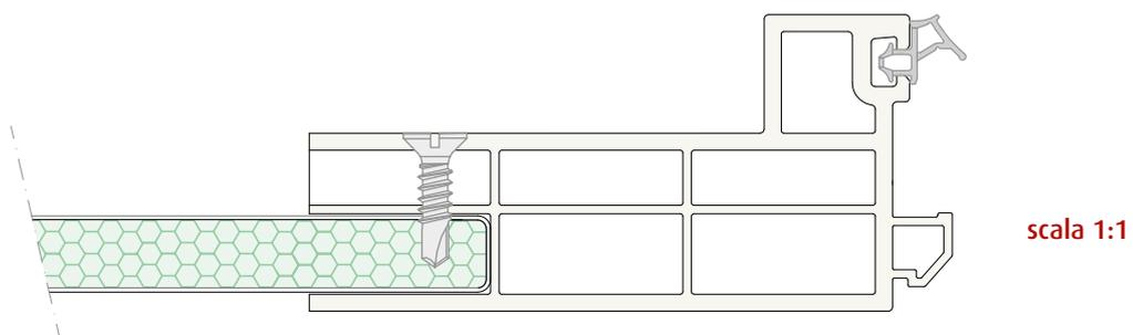
È inoltre possibile rifilare il profilo in più posizioni per accoppiarlo con un ciellino da 10mm di spessore (con supplemento di prezzo)
